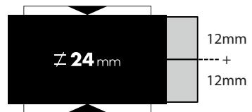
La resistenza di 2 lastre di 12mm di spessore, incollate assieme con colla speciale garantisce sforzo di rottura di  $\geq 20000$  N\*\*.
